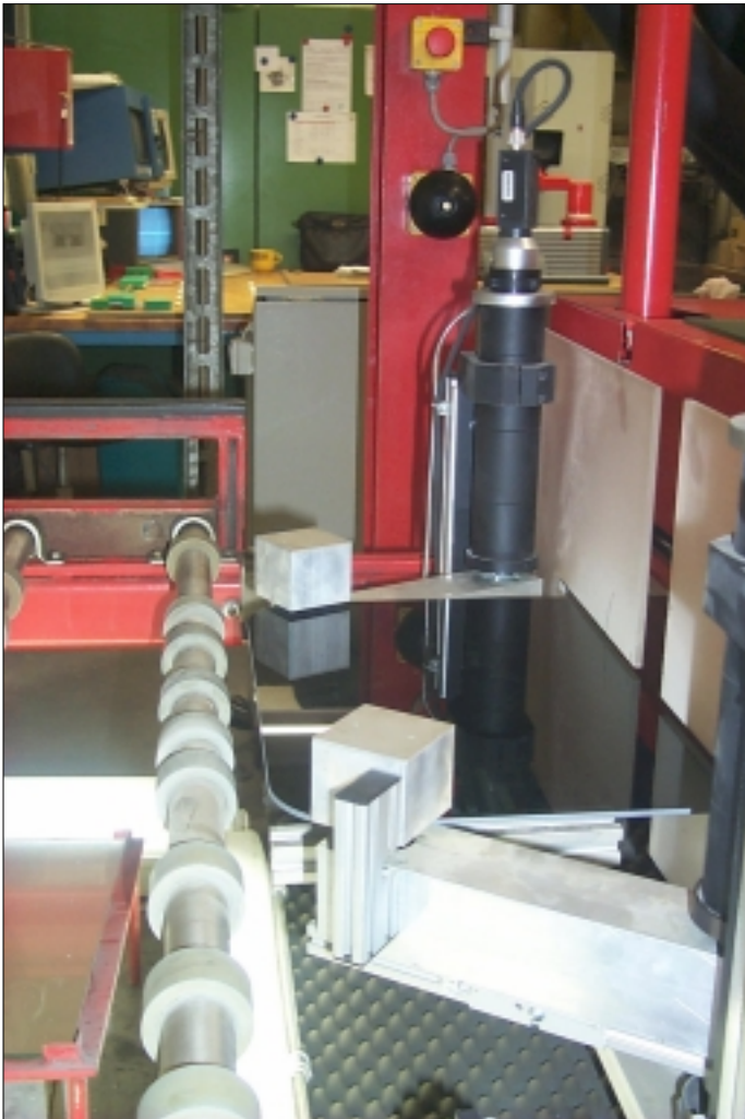
Scheibenrandprüfung in der Produktion
