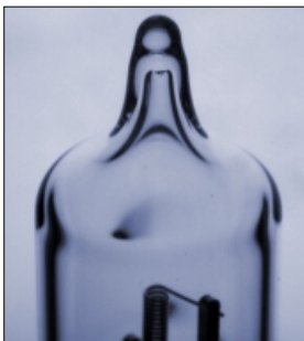
Glasfehler an der Schulter und am Kolben
