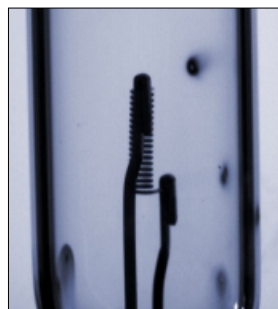
Glasfehler an der Schulter und am Kolben
