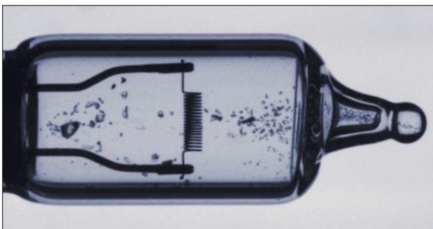
Splitter im Kolben
