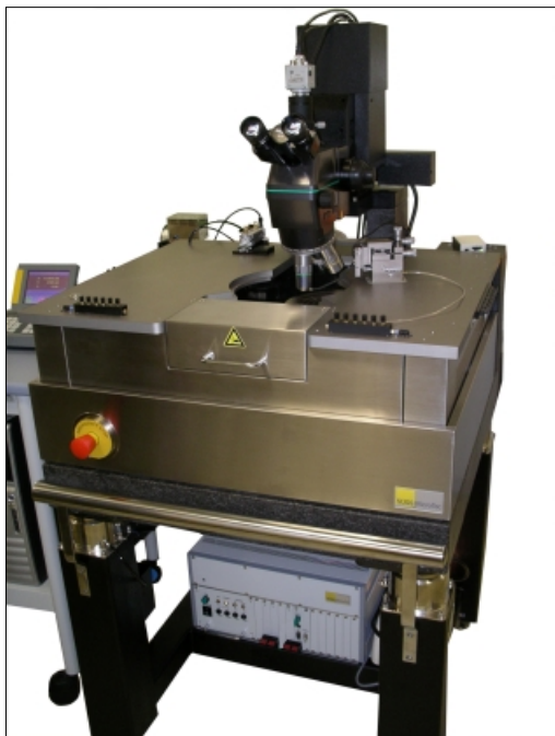
Prober PA200 von Süss MicroTec mit integrierter optischer Prüfung
